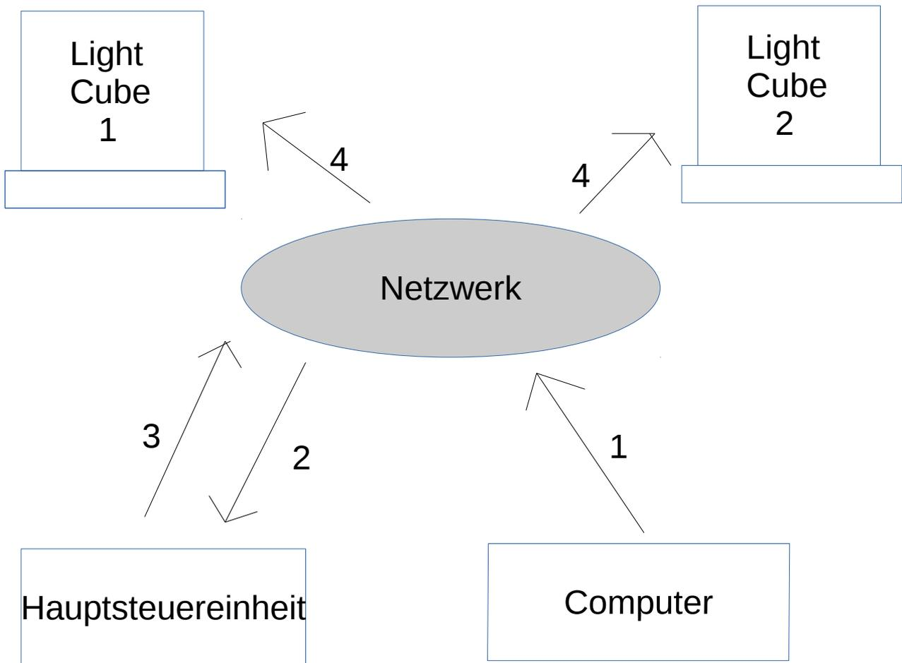
1 und 2: Der Computer ist mit dem Netzwerk verbunden. Der PC remotet sich auf die Hauptsteuereinheit.
