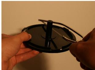
Mit Hilfe einer Rundfeile ein 2mm tiefes Kreuz feilen, als Halterung der Quadbrille. (Bei Bedarf Schablone benutzen)
