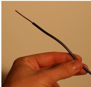
Das Kabel immer genau nach 29mm scharf rechtwinklig biegen und auf den Biegeradius der Zange achten. (Bei Bedarf Biegevorrichtung benutzen.)
