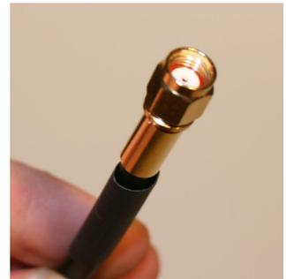
Und mit der Crimpzange befestigen. Danach den Schrumpfschlauch drüber und erhitzen.
