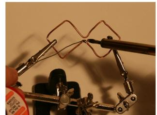
Das RG58 Kabel auf einer Seite ca. < 1cm abisolieren und wie auf dem Bild verdrehen.
